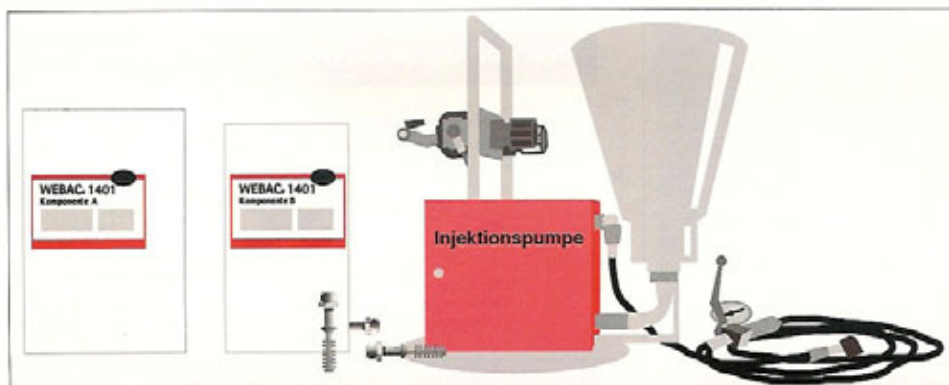
Beispiel Harz-Fluss: Von den Gebinde-Komponenten über die Injektions-Pumpe durch den Schlagpacker
